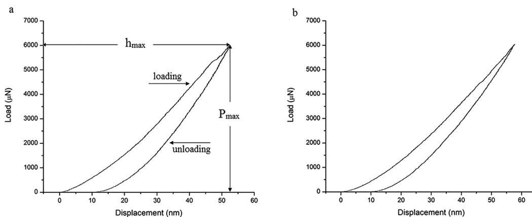
Fig. 2. Load–displacement curves of sintered samples: a) WC + 5 wt%  $W_xSi_y$ . b) WC + 10 wt%  $W_xSi_y$ .
