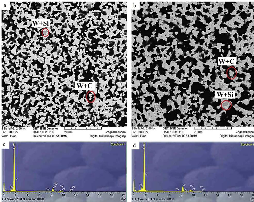
Fig. 6. SEM micrographs of sintered samples: a) WC + 5 wt%  $W_xSi_y$ , b) WC + 10 wt%  $W_xSi_y$ . EDS analysis of sintered samples: c) WC + 5 wt%  $W_xSi_y$ , d) WC + 10 wt%  $W_xSi_y$ .
